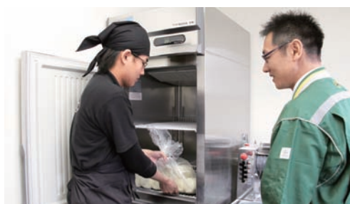
練った粉をまとめて棒状にし、熟成庫（写真右）で2回熟成させると、のどごしのよいうどんができる。一連の作業を任されている八木橋武央さん。
