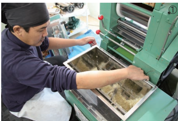
店の一角にある製麺機 ①小麦粉を練って ②帯状に伸ばす ③スープにマッチする中太麺のできあがり
