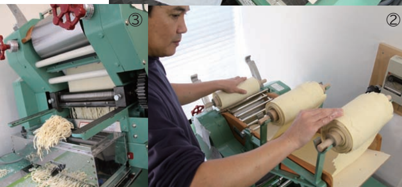
店の一角にある製麺機 ①小麦粉を練って ②帯状に伸ばす ③スープにマッチする中太麺のできあがり
