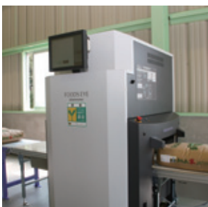
コンベアに載せるだけで1分間に30キロのお米約6袋を検査
