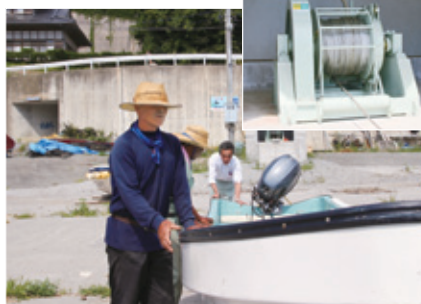
船を浜にあげる巻き揚げ装置(綾里漁港、港地区に4機設置)
