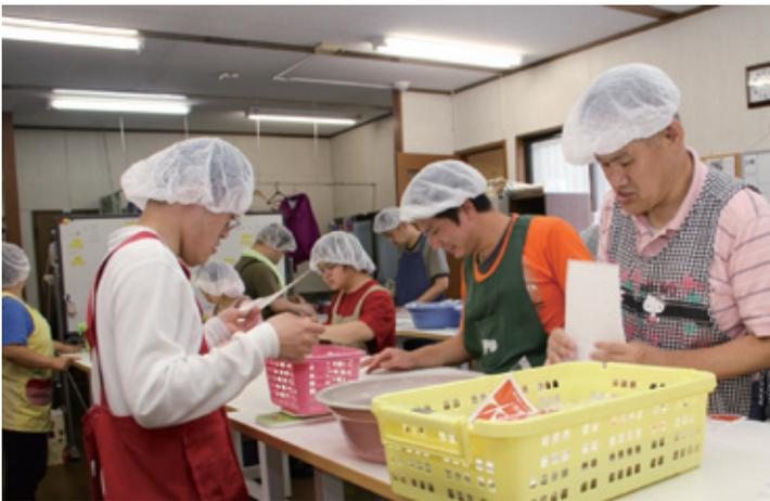
●「働くちから革新塾」ではDM発送・封入作業にライン・工程方式を導入。実際に塾生の施設や事業所に赴き、働きやすい仕事場への環境改善、利用者それぞれが能力を発揮しやすい作業分担の方法や作業手順の見える化などを具体的にアドバイスすることで、生産効率のアップを図っている。
