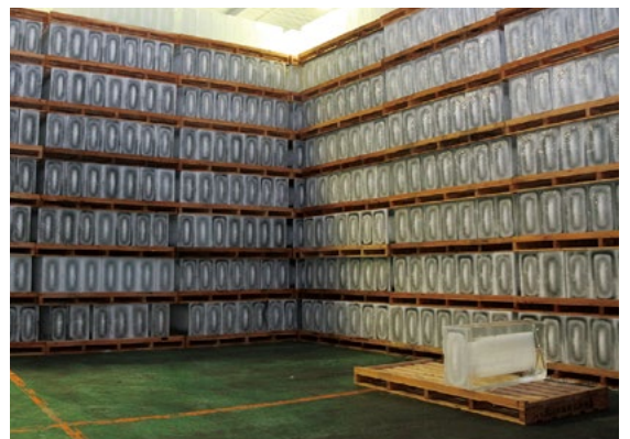
できあがった氷、約2000tを貯氷可能 角氷1枚が143kg、7枚で約1tにもなる
