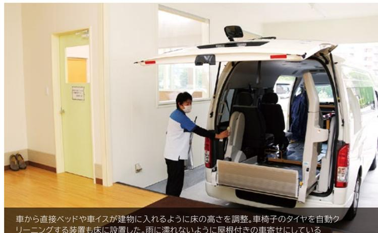
車から直接ベッドや車イスが建物に入れるように床の高さを調整。車椅子のタイヤを自動クリーニングする装置も床に設置した。雨に濡れないように屋根付きの車寄せにしている
