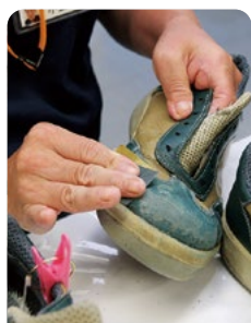
傷の部分をヤスリで補修
