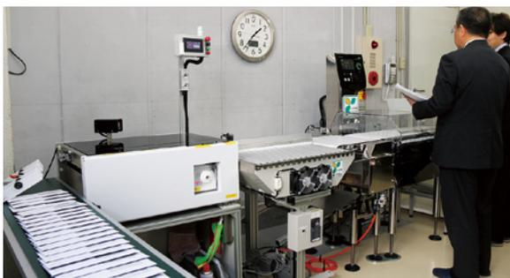
助成で購入した自動重量検査機で封筒の重さを瞬間にチェック
