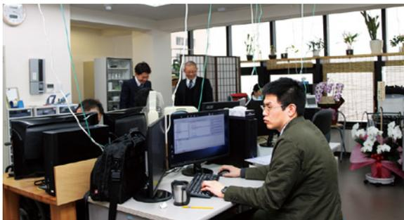
車椅子のタイヤで傷つけないようケーブルを天井に配線、テーブルにはキャスターを付けて稼働式に
