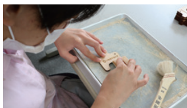
レーザー加工機で切り出した製品を、木作業班の利用者さんが丁寧にヤスリがけし仕上げます
