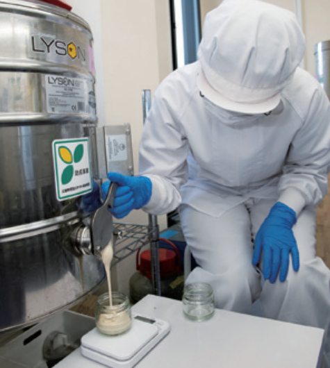
新型コロナウイルス感染症対応臨時助成金で整備した「50Lクリーミング器」。ほぼ全自動でクリーミーはちみつを製造できる
