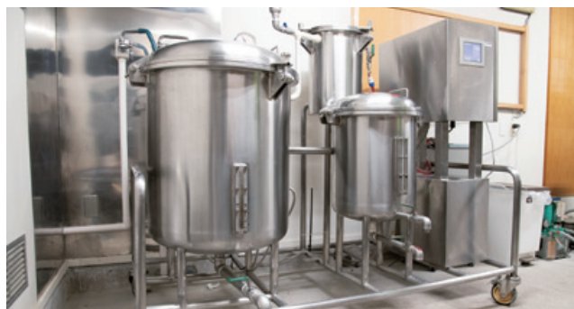
設置されたばかりの減圧蒸留器を試運転
