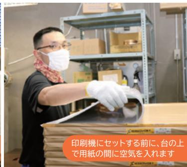
印刷機にセットする前に、台の上で用紙の間に空気を入れます
