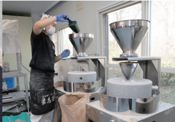
整備した電動石臼製粉機。ゆっくりと石臼を回し挽くことで、熱に弱いそば粉にしっかりと風味が残ります。挽き立てを製麺できるのは、製粉機が自前だからできること
