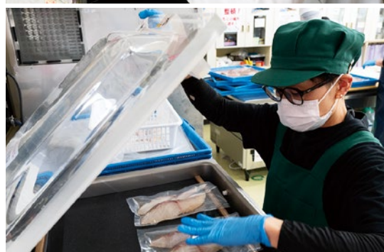
〈上〉下処理した魚は、助成で整備した食品乾燥機へ。ワンボタンで翌日には、ばっちり仕上がります 〈下〉レストラン業務と兼務の利用者さん。商品をていねいに真空包装機でバックしていきます。複数の袋も一度に封ができるスグレもの
