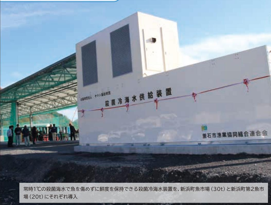
常時1℃の殺菌海水で魚を傷めずに鮮度を保持できる殺菌冷海水装置を、新浜町魚市場（30t）と新浜町第2魚市場（20t）にそれぞれ導入
