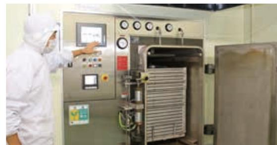
再開した釜石工場には、助成で導入した加熱、調理、殺菌、冷却までできる圧力容器も(当時)
